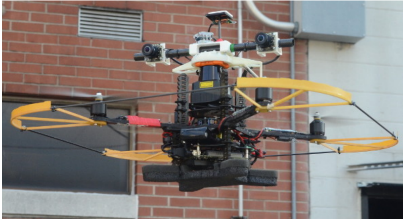
1750 g (laser, 3 cameras, GPS, IMU)
